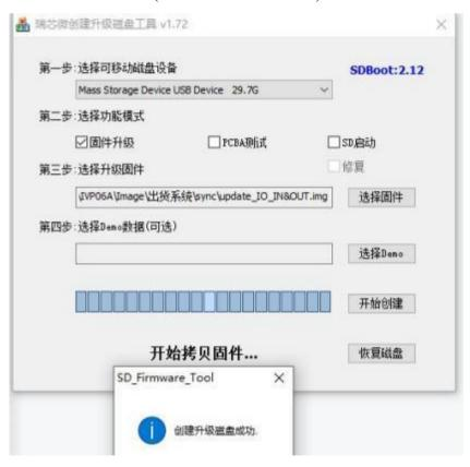
2) 做卡完成后,正常卸载磁盘,然后将 SD 卡插入盒子卡槽重新上电进行烧写,等待几分钟烧写之后拔出 TF 卡。
