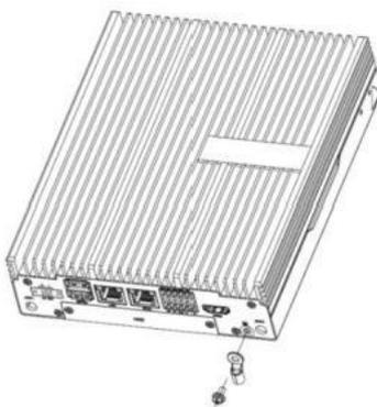
**步骤 4** 将接地线缆另一端与连接大地(如墙面等)的接地端子相连。
