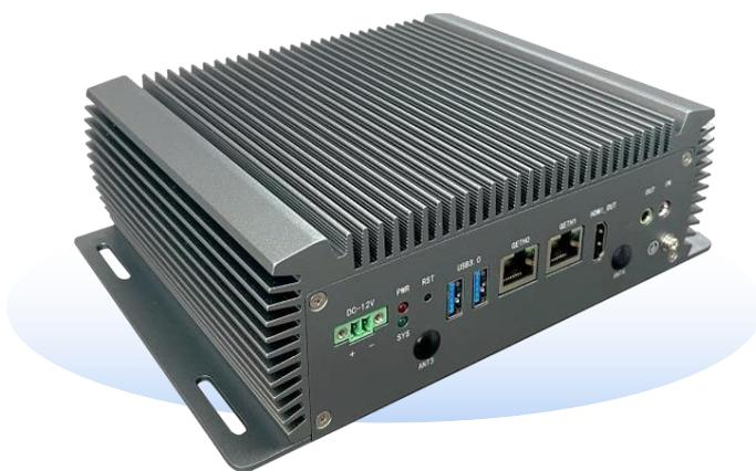
**DA160S** 采用高集成BM1688智能视觉深度学习芯片，搭载8核ARM A53处理器，主频1.6GHz，提供**16TOPS@INT8**的算力，支持**16路**高清视频智能分析。
