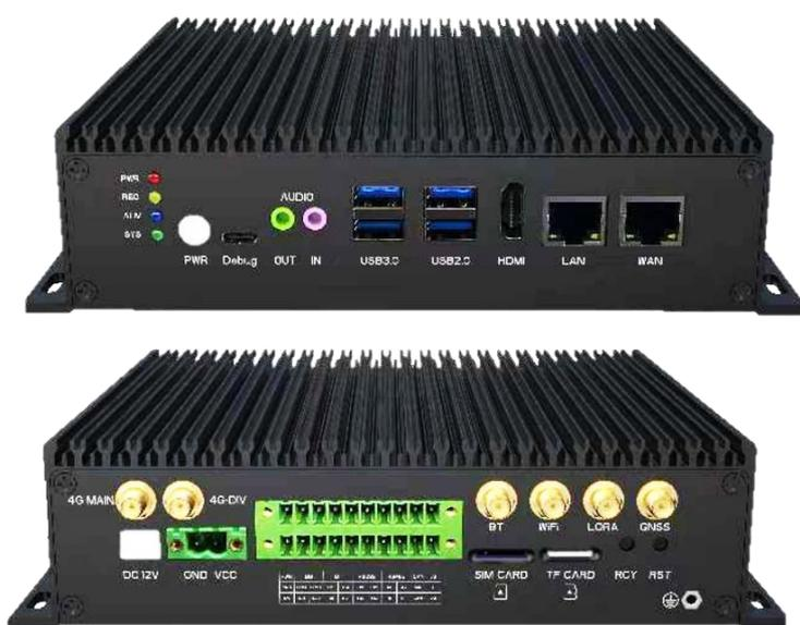
DA160S采用高集成**BM1688**智能视觉深度学习芯片，搭载8核ARM A53处理器，主频1.6GHz，提供**16TOPS@INT8**的超强算力，支持**16路**高清视频智能分析，兼容混合精度运算，兼具高性能与低功耗，接口丰富，适应性强，配合多种深度学习算法，轻松应对智慧城市、商业和能源等多场景，为边缘计算提供强大数字化支持。
