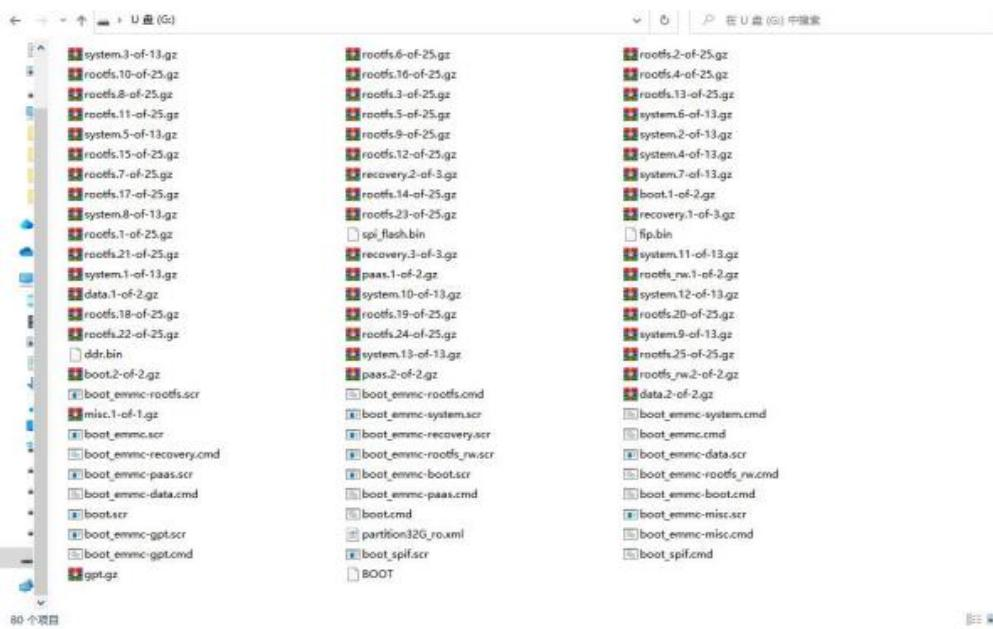
•步骤 2 插入 TF 卡，重新上电，待烧写完成，会看到拔掉 TF 卡并重启的提示，我们拔出 TF，重新上电即可进入新的系统。
